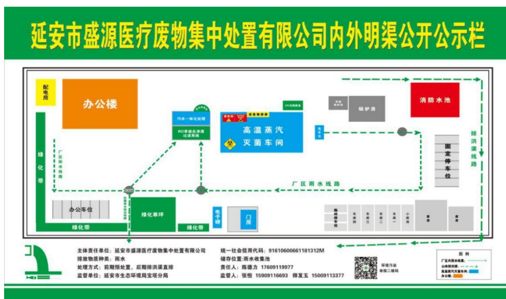
图 3.2-1 厂区雨水收集排放去向示意图
