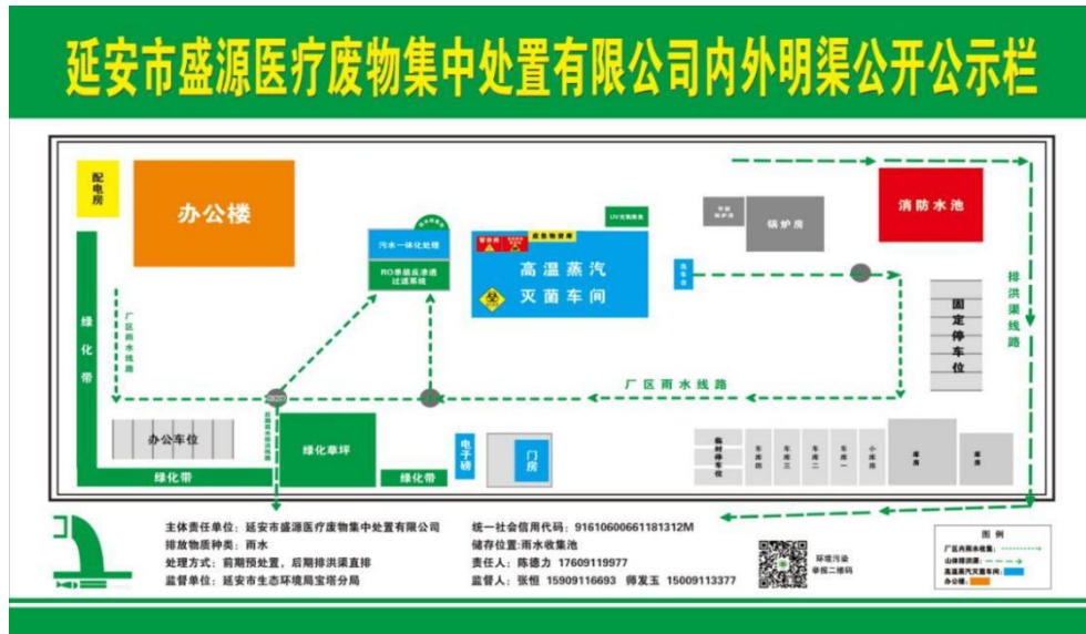
图 4.2-1 厂区雨水收集排放去向示意图
